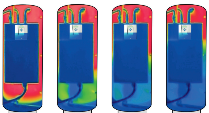
Entladung durch Frischwassererwärmer
