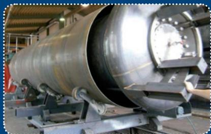
Soweit möglich erfolgt die Montage im Werk, alternativ wird der Speicher in Modulen angeliefert und vor Ort montiert.
