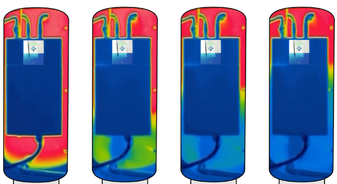
Entladung durch Frischwassererwärmer
