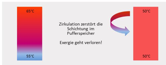
Um solche, nicht sinnvoll nutzbaren Temperaturniveaus zu vermeiden, haben BMS-Energietechnik AG und varmeco GmbH & Co. KG die eXergiemaschine eXm entwickelt.
