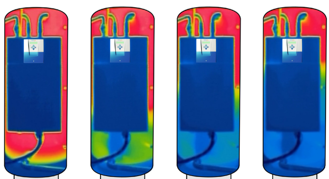
Entladung durch Frischwassererwärmer
